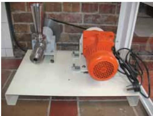
**Figura 20.** Extrusora tipo *expeller* para la extracción de grasas de semillas de copoazú y
